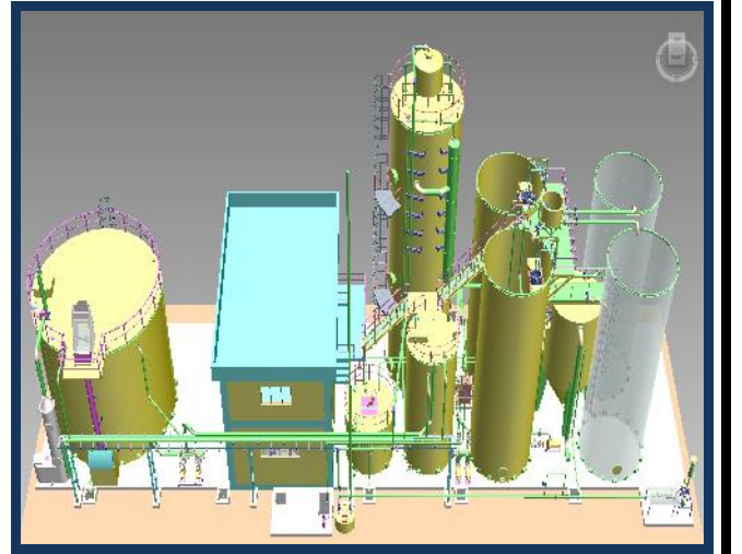
KOKU WET SCRUBBER 3D GENEL GÖRÜNTÜ
